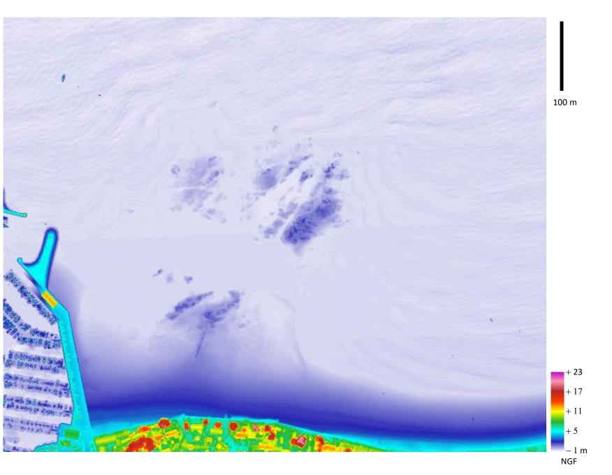
Modèle Numérique de Terrain (MNT) ou enveloppe inférieure des échos discrets du laser infrarouge complétée par l'interpolation du sol sous un sursol obtenu par la classification de nuages de points formant des parois planes en bâtiments et des nuages de points formant des volumes de branches et feuillage en arbres.
