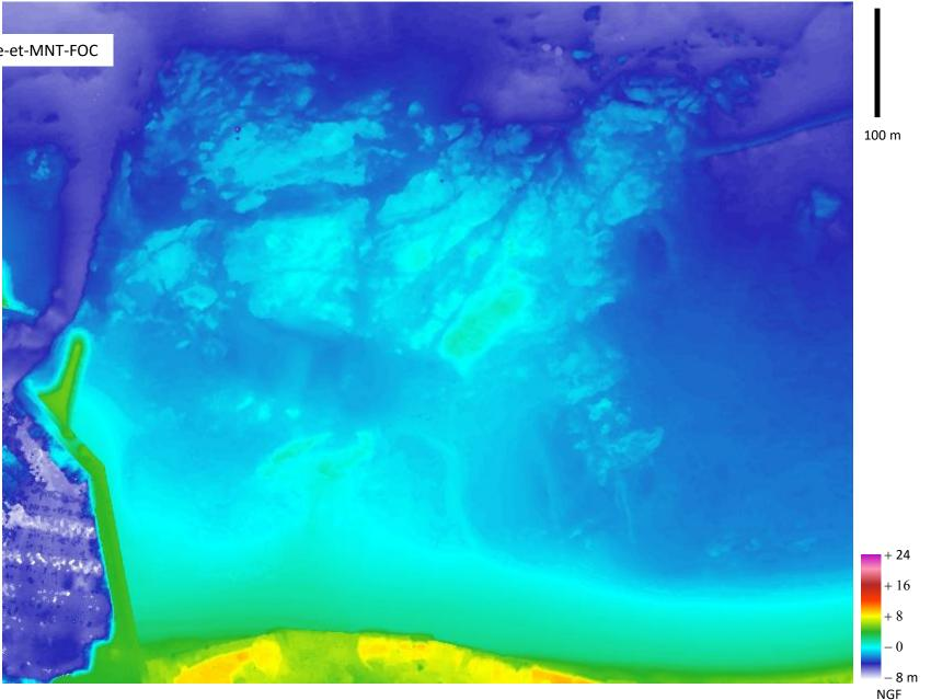
La base de la forme d'onde doit être corrigée de la demi-largeur de la forme d'onde de l'écho de fond pour donner la bonne altitude (voir Launeau et al 2019).
