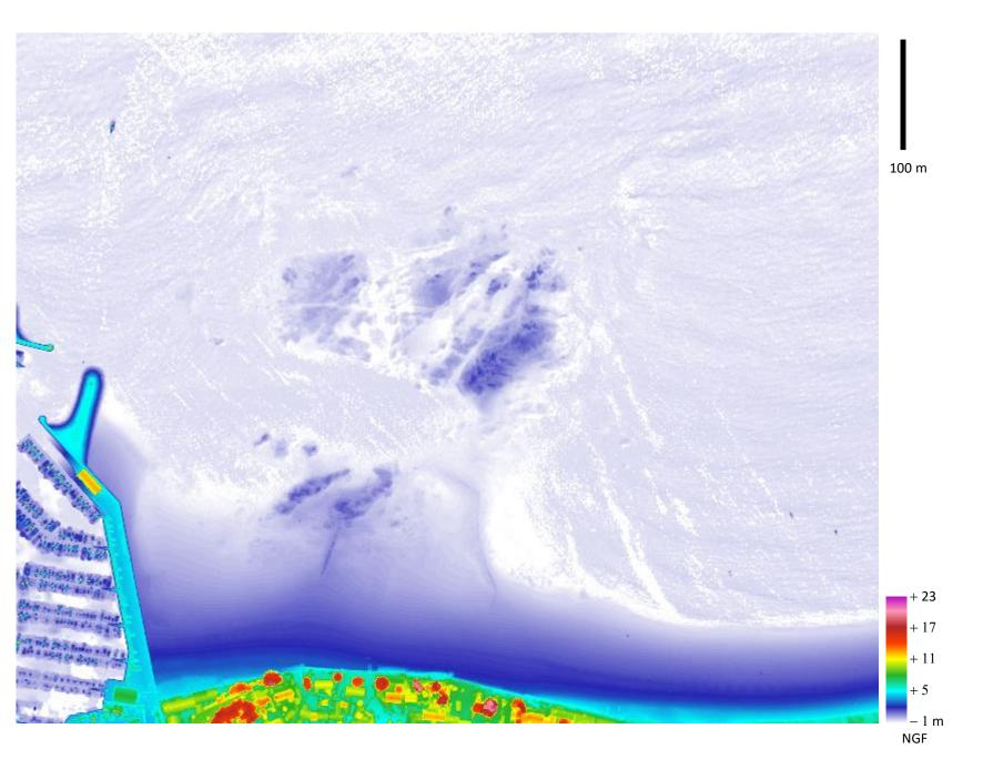
Le laser vert pénétrant dans l'eau le fond de l'eau est interpolé sous les bateaux.
