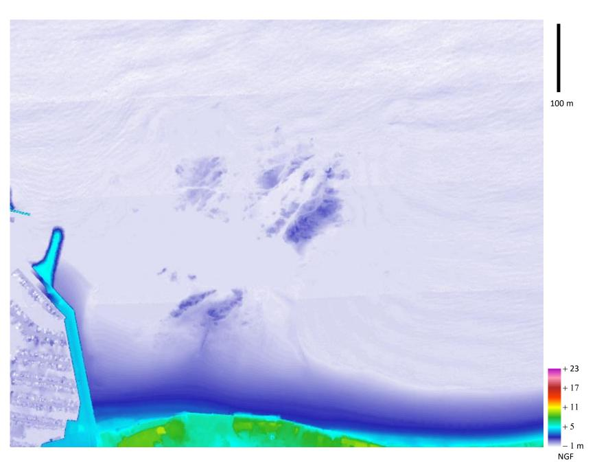
Modèle Numérique de Surface (MNS) ou enveloppe supérieure des échos discrets du laser vert
